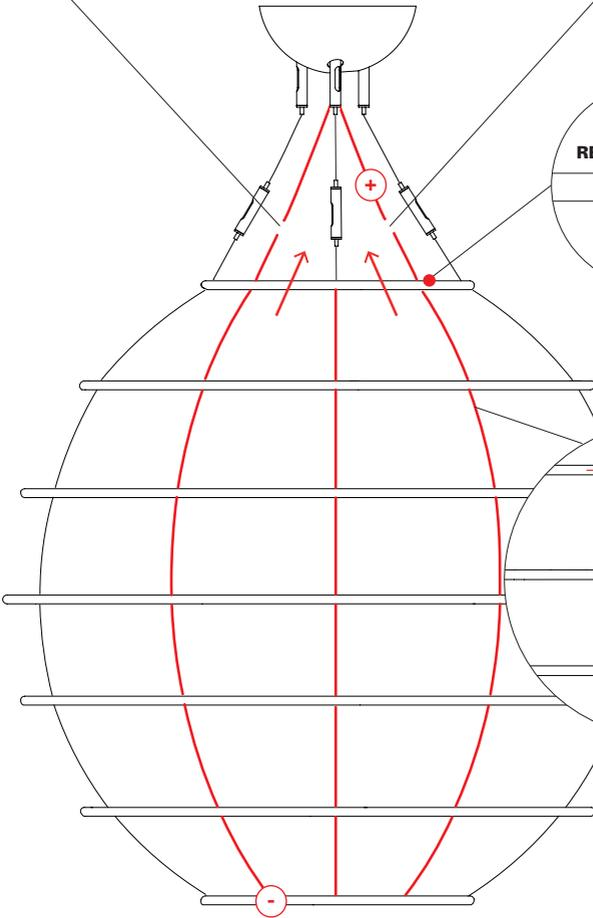
Prima di montare le cover per LED, collegare la lampada e controllare che tutti i LED funzionino correttamente.
